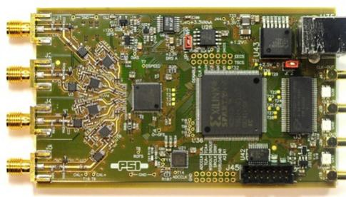
**Abbildung 4.9:** Platine mit dem DRS4-Chip. Auf der linken Seite sind die vier  $50\ \Omega$  terminierte Input-Kanäle zu erkennen [Hom13].
