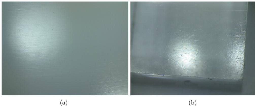
**Abbildung 4.10:** Verschiedene Szintillatoroberflächen. a) Mit einem Diamantkopf polierte Oberfläche. Die charakteristischen Bearbeitungslinien sind in horizontaler Richtung zu erkennen. b) Abgenutzte raue Oberfläche.
