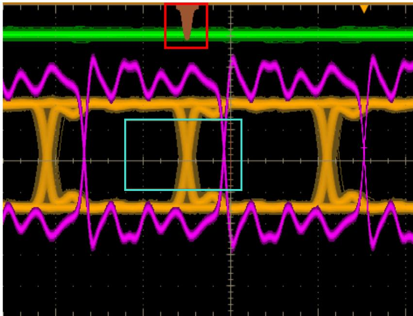
Abbildung 9.1: Oszilloskopbild der VCO Clock zur Messung des Jitters.
