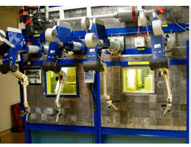
Chemische Prozesse wie Auslaugen oder Auflösen werden in einer komplexen «Heissen Zelle» durchgeführt. Die aufgelösten Proben werden anschliessend mit verschiedenen nasschemischen Methoden analysiert.
