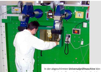
In der abgeschirmten **Universalprüfmaschine** können mechanische Eigenschaften hochradioaktiver und stark kontaminierter Proben (z. B. Brennstab-Hüllrohr-Stücke) untersucht werden. Die integrierte Ofenkammer lässt Tests bei Temperaturen bis 800 °C und den Einsatz verschiedener (Inert-) Gase zu. Das Materialverhalten kann in-situ mit einer hochauflösenden Kamera beobachtet werden.
