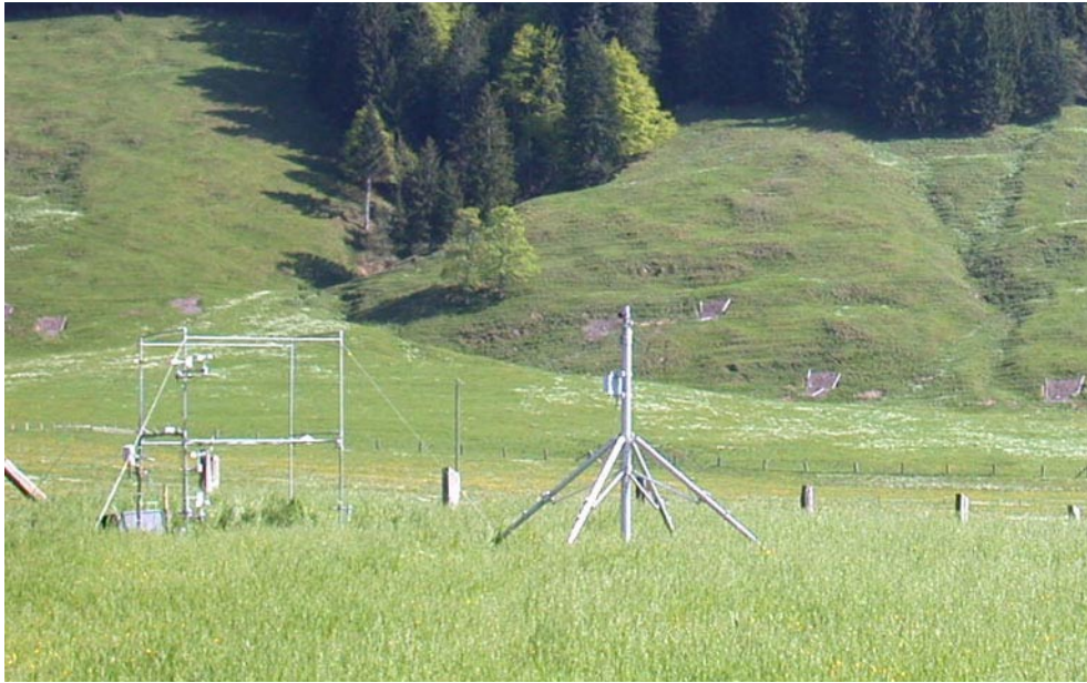
Abb. 1: Die Messstation in Hinterseeboden. Links steht das Gerüst für die mikrometeorologischen Messungen (Profile von Wind, Temperatur, Feuchte, Strahlung). Rechts der Mast für die Flussmessungen.
