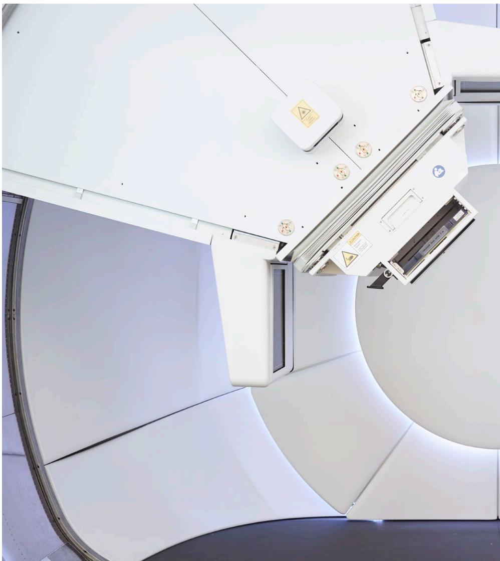
Avec la technique *Spot Scan* – appelée aussi *pencil beam scanning* – un faisceau de protons hautement concentré de 5 à 7 millimètres d'épaisseur, aussi fin qu'un crayon, balaie tout le volume de la tumeur, point par point, niveau par niveau. Les tissus qui environnent la tumeur ne sont donc pratiquement pas affectés. Le point décisif de cette méthode réside dans la technique de direction du faisceau de protons qu'abrite une installation d'environ 200 tonnes: la Gantry. Cet engin
