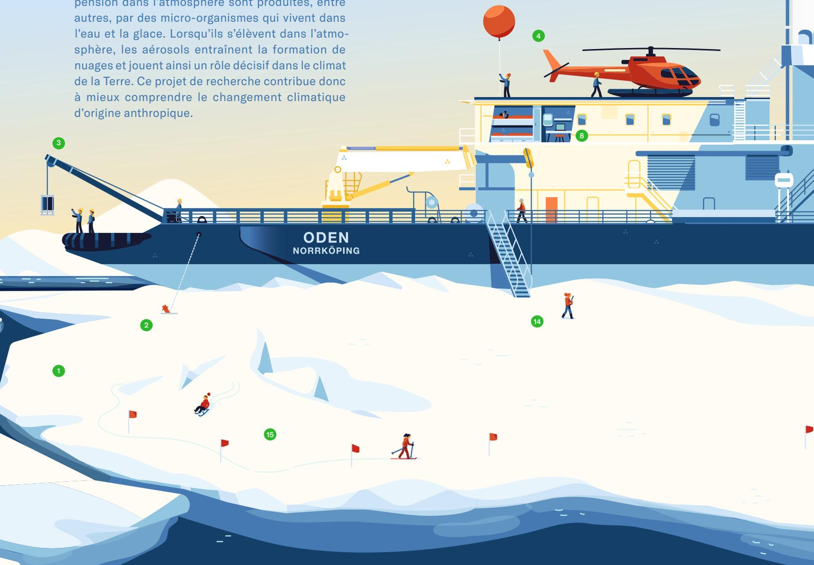
**1** Banquise d'une superficie équivalente à environ 300 terrains de football et d'une épaisseur pouvant atteindre 6 mètres. Elle devait être suffisamment solide pour supporter le poids de tout l'équipement et en même temps suffisamment mince pour être percée et permettre le passage du **16** véhicule submersible et des **19** carottes de glace.
