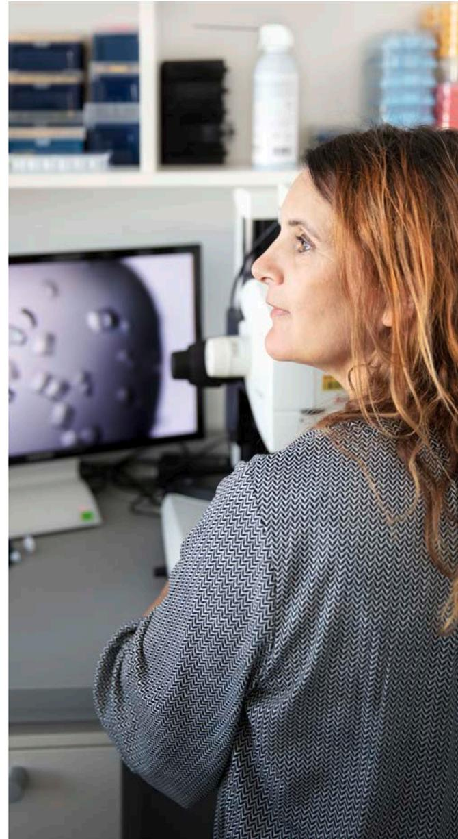
Florence Pojer bereitet Proteinkristalle für den Transport an das PSI vor. Unter dem Stereomikroskop selektiert sie einzelne Kristalle und friert sie in Flüssigstickstoff ein.
