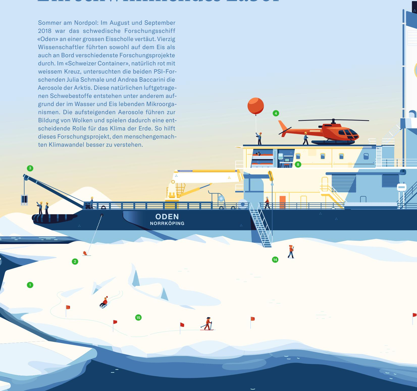
**1** Eisscholle, etwa so gross wie 300 Fussballfelder und bis zu 6 Meter dick. Die Eisscholle sollte einerseits mächtig genug sein, um die ganze Ausrüstung zu tragen und andererseits dünn genug, damit sie für das **16** Unterwasserfahrzeug und die **19** Eiskerne durchbohrt werden kann.
