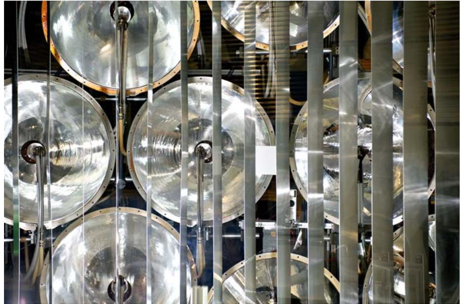
Die zehn Xenon-Lampen des Solarsimulators erzeugen für Experimente künstliches hochkonzentriertes Sonnenlicht.
