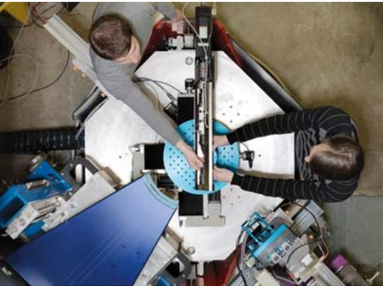
Vadim Davydov und Steven Van Petegem justieren eine Zugmaschine auf dem Probenstisch des Instruments POLDI. Dabei bereiten sie eine Spannungsfeldmessung während des Zugversuches vor.
