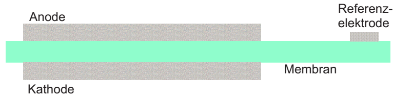
Abbildung 3.8: Seitliche Anordnung der Referenzelektrode. Die Elektrolytbrücke wird durch die Membran selber gebildet. Als Referenzelektrode kann entweder eine Wasserstoffreferenzelektrode oder eine Calomel-Referenzelektrode dienen.
