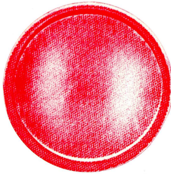
Abbildung 3.2: Druckverteilung in einer R28SS-Zelle, sichtbar gemacht durch eine mehr oder weniger starke Einfärbung der Druckmessfolie Typ LW von Fuji Photo Film Co, Tokyo, Japan. Die hellsten Zonen entsprechen einem Anpressdruck von etwa 4 \pm 1 MPa, an den dunkelsten Stellen beträgt sie etwa 9 \pm 1 MPa. Der stark eingefärbte Aussenring entspricht dem Druck auf der ringförmigen Teflondichtungfläche und stellt keine aktive Fläche dar.
