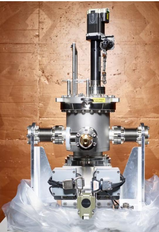
Damit die Experimente am SwissFEL gelingen, muss sichergestellt werden, dass die Röntgenlichtpulse die für die Experimente erforderlichen Eigenschaften erfüllen. Zum Beispiel ermittelt das abgebildete Gerät die genaue Position der einzelnen Röntgenlichtpulse.
