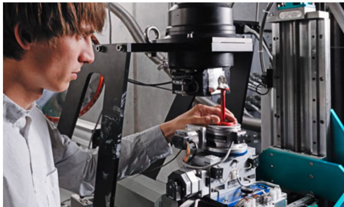
Stefan Hartmann, Ingenieur bei Eberhard Lehmann, richtet ein Tomografie-Experiment ein, das an der ICON-Anlage für Neutronenimaging mit höchster Auflösung durchgeführt wird.
