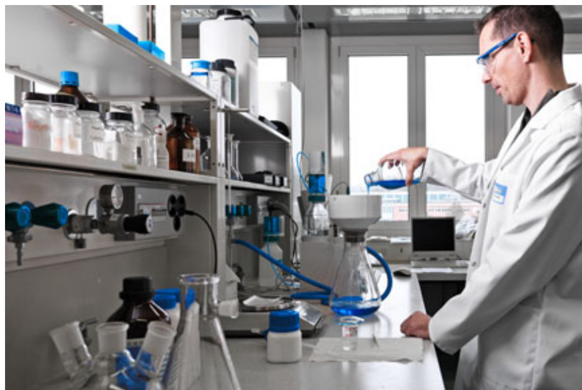
Sandro Brandenberger bei der Präparation metallausgetauschter Zeolith-Katalysatoren.
