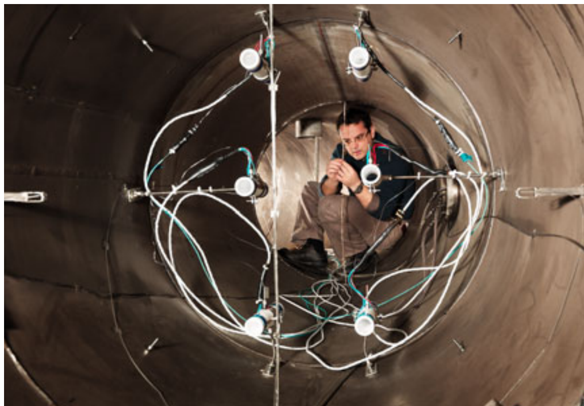
Domenico Paladino prüft die Einspritzvorrichtung für das Olivenöl, mit dem sich die Strömungen und Turbulenzen des Kühlwassers in PANDA aufzeigen lassen.
