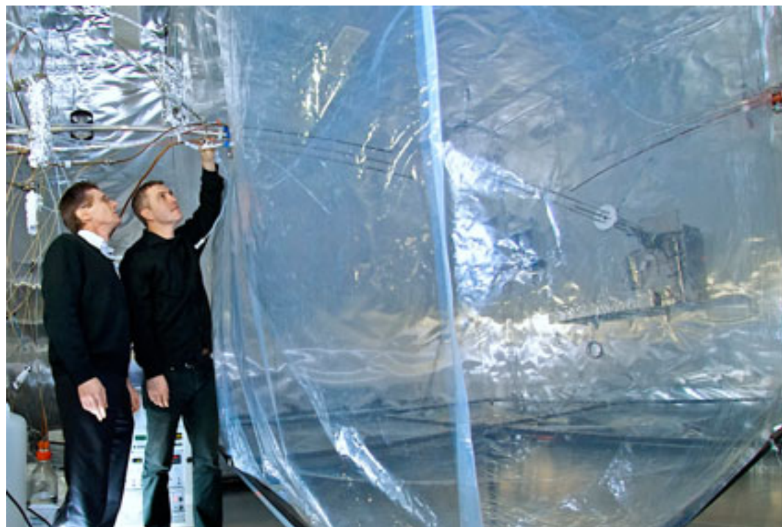
PSI-Forscher Urs Baltensperger (links) und André Prévôt in der Smogkammer des PSI, in der Vorgänge in der Atmosphäre simuliert werden.
