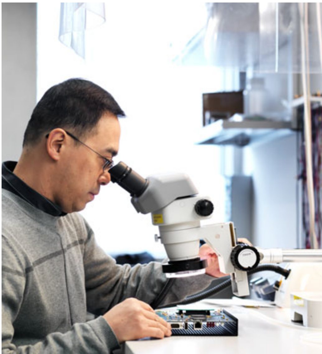
Xintian Shi, der die Chips für den European XFEL-Detektor entwirft, untersucht einen Chip, der die Messwerte aus einem Pixel des Detektors ausliest.
