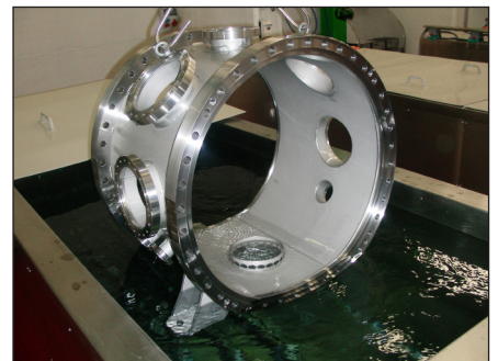
UHV – Komponente während der Ultraschallreinigung-Reinigung.
