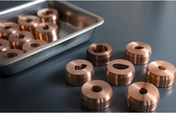
Les collimateurs sont des dispositifs perforés fabriqués sur mesure au PSI. Avant le traitement, ils sont serrés dans un appareil à travers lequel le faisceau de protons est dirigé vers l'œil. L'obturateur est fraisé en suivant la forme de la tumeur. Il permet au faisceau de protons de n'atteindre que la tumeur oculaire et de ne pas irradier les autres tissus sains de l'œil. Cette technique est utilisée au PSI spécialement pour les tumeurs oculaires.
