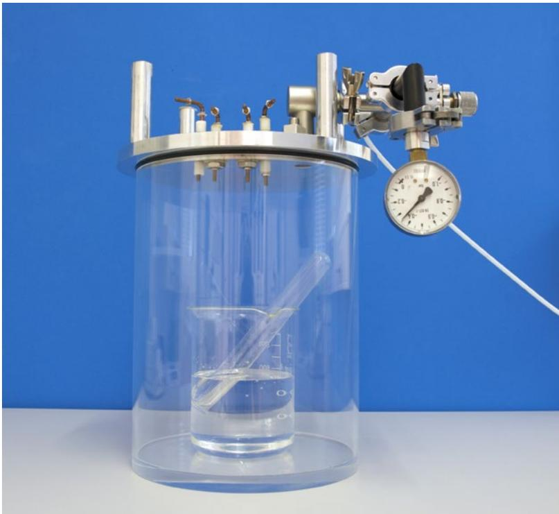
→ Beim Abpumpen dehnt sich die Luft im Reagenzglas aus und entweicht durch die Öffnung. Lässt man die Luft wieder in die Glocke einströmen, steigt der Druck auf die Wasseroberfläche wieder an und presst Wasser ins Reagenzglas. Dadurch wird die Restluft im Reagenzglas zusammengedrückt, bis ganz oben nur noch eine kleine Luftblase sichtbar ist.
