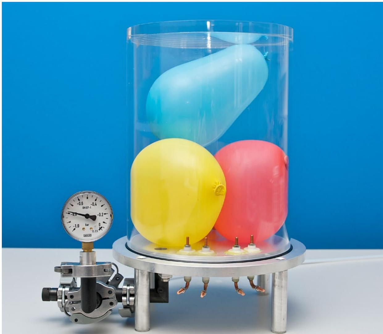
→ Wenn man die Luft in der Vakuumpumpe abpumpt, sind in den Ballons auf gleichem Raum mehr Luftmoleküle vorhanden als ausserhalb. Mit durchschnittlich etwa Schallgeschwindigkeit (343 m/s) stossen diese gegen die Ballonwand und drücken sie nach aussen, ähnlich wie wenn Menschen bei einem Gedränge die Abschränkungen wegdrücken. Deshalb füllen die nur leicht aufgeblasenen Ballons nach und nach fast das ganze Volumen der Vakuumpumpe aus.
