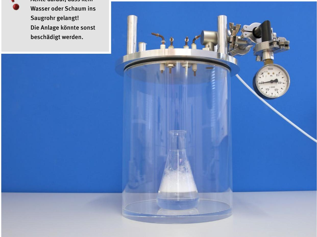
→ Analog dem Experiment 1 mit den Ballons dehnt sich die Luft in den Seifenblasen aus, deshalb wachsen die Seifenblasen im Vakuum.
