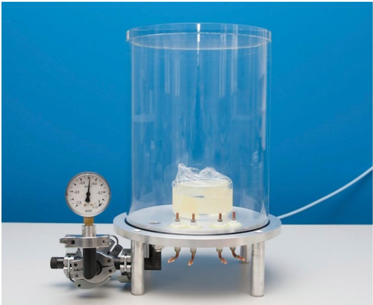
→ Beim Abpumpen entweicht die Luft aus dem Glasgefäss durch mehrere kleine Spalte zwischen Folie und Gefäss. Beim anschliessenden Einströmen der Luft in die Vakuumblocke drückt diese die Folie auf das Glasgefäss und schliesst es luftdicht ab. Dadurch entsteht eine Druckdifferenz zwischen innerhalb und ausserhalb des Gefässes. Auf eine  $20 \text{ cm}^2$  grosse Folie wirkt so nach einem vollständigen Vakuum eine Kraft, die dem Gewicht von etwa 20 kg Masse entspricht: Die Folie zerreisst.
