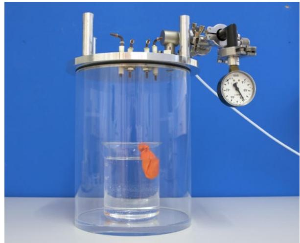
→ Bei der Reduktion des Luftdrucks im Vakuumgefäss dehnt sich die Luft im Ballon aus, weil der Druck auf die Wasseroberfläche und damit auf die Ballonhülle kleiner wird. Der Ballon wird dadurch grösser und verdrängt mehr Wasser: Der Auftrieb vergrössert sich entsprechend und der Ballon steigt auf.
