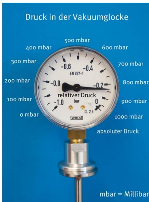
Das Manometer zeigt den Druck in Bar an. 1 bar entspricht 1000 mbar (Millibar). Unser Manometer zeigt die Abweichung vom normalen Umgebungsdruck, also den relativen Druck an. Steht auf der Anzeige  $-0.4$  bar, herrscht demnach ein absoluter Druck von 600 mbar. In dieser Anleitung wird der Druck stets in mbar angegeben.
