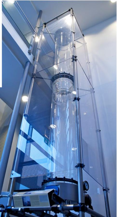
→ Eine Platte, welche die Querschnittsfläche des Vakuumgefäßes einnimmt, fällt in Luft langsam nach unten, ähnlich einem offenen Fallschirm. Im Vakuum müssen wesentlich weniger Luftmoleküle durch den schmalen Spalt rund um die Platte nach oben fließen: Die Platte fällt deshalb beinahe ungebremst.
