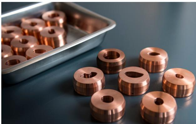
I collimatori sono diaframmi realizzati su misura al PSI. Prima del trattamento vengono fissati in un apparecchio che indirizzerà il fascio di protoni verso l'occhio. Il foro del collimatore riproduce la forma del tumore in modo che il fascio di protoni colpisca solo il tumore e non irradi il rimanente tessuto sano dell'occhio. Al PSI, questa tecnica viene usata appositamente per i tumori oculari.
