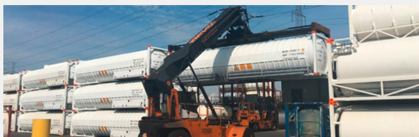
Fig. 2 Tanks in Schiffscontainerrahmen für den Transport von verflüssigtem Methan.
