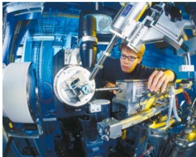
**Der Star:** Die SLS mit der bestehenden Strahllinie für Protein-Kristallografie (Bild H. R. Bramaz).
