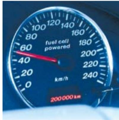
**Langlebig:** 200'000 km bei durchschnittlich 50 km/h entspricht einer Betriebsdauer, welche die Brennstoffzellen-Membran im Dauertest erreicht.
