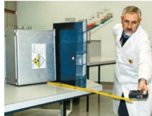
Messtechnik: Wie hoch ist die Dosisleistung aus dem Versandbehälter?
