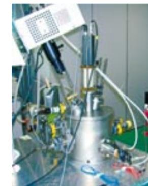
**Das PSI-Reflektometer:** Weisses Licht wird von oben links auf die Probe (im Metallbehälter) gerichtet und gibt Aufschluss über deren Strahlungseigenschaften.
