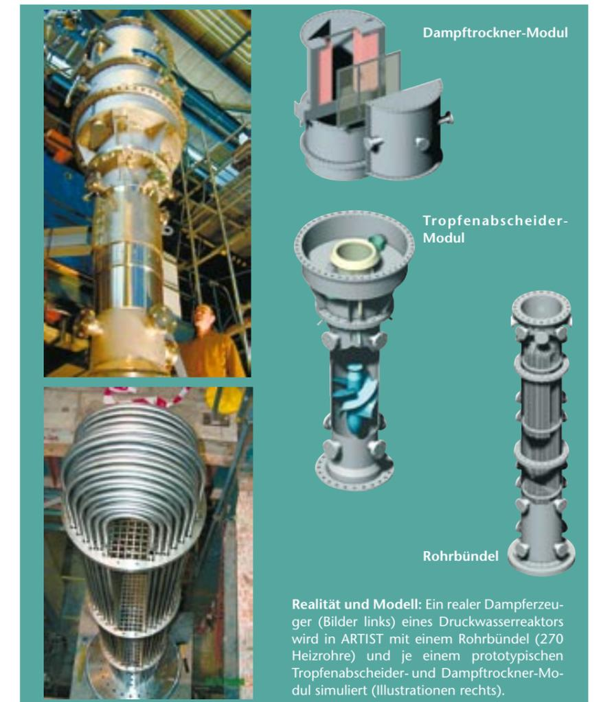
Realität und Modell: Ein realer Dampferzeuger (Bilder links) eines Druckwasserreaktors wird in ARTIST mit einem Rohrbündel (270 Heizrohre) und je einem prototypischen Tropfenabscheider- und Dampftrockner-Modul simuliert (Illustrationen rechts).
