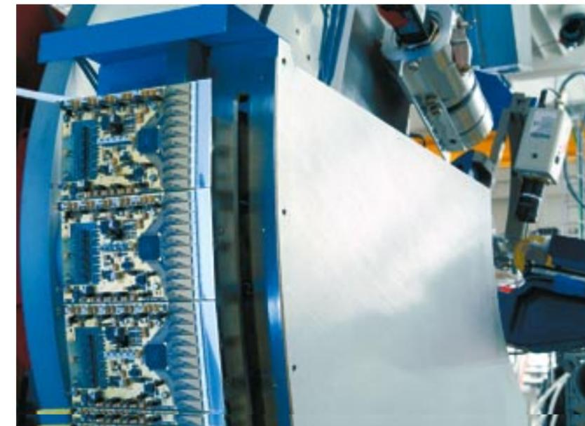
Streifendetektoren (vorne links) an einer Strahllinie der SLS. Rechts hinten sitzt die Probe, wo die Synchrotronstrahlen abgelenkt werden und danach auf die Detektoren treffen.
