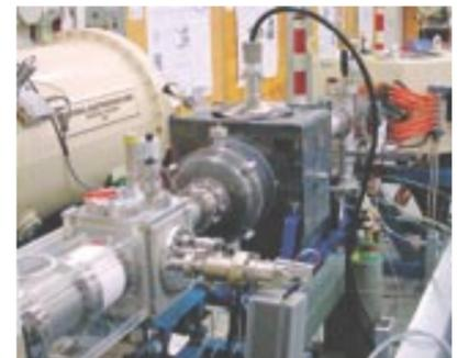
Die neu entwickelte Beschleunigungsstufe (Bildmitte) der AMS-Anlage ermöglicht Radiokarbon-Datierungen auf kleinstem Raum.
