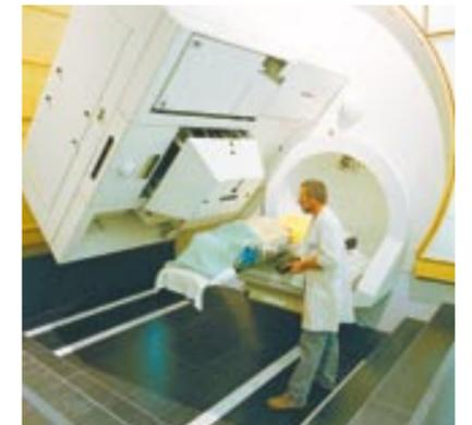
**Die Gantry** der Protonentherapie-Anlage am PSI ermöglicht eine weltweit neuartige Bestrahlungstechnik.
