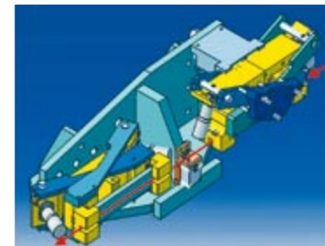
Fokussierende Optik für Brennpunkte im Mikrometerbereich, entwickelt für die neue Röntgen-Absorptionslinie LUCIA von den französischen Partnern SOLEIL und LURE (Modellzeichnung).
