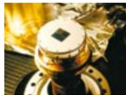
**UHV-Kryostat:** Der neue Ultrahochvakuum-Temperaturregler mit Probenhalter (rechts) ist eine Eigenentwicklung des PSI und sorgt für die nötige Abkühlung, damit u. a. die Messungen an supraleitenden Blei- und Niobfilmen durchgeführt werden konnten.
