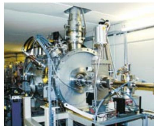
Das Kühlmodul der Kavität, das die Supraleitung ermöglicht, ist in der Strahlführung des Speicherrings installiert.
