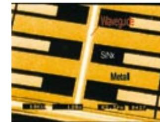
**Verlustfreie Lichtführung:** Chip mit optischem Wellenleiter (Waveguide: eigentliche Wellenleitung; goldfarbig: Kontaktpads;  $\text{SiN}_x$ : Isolierschicht).
