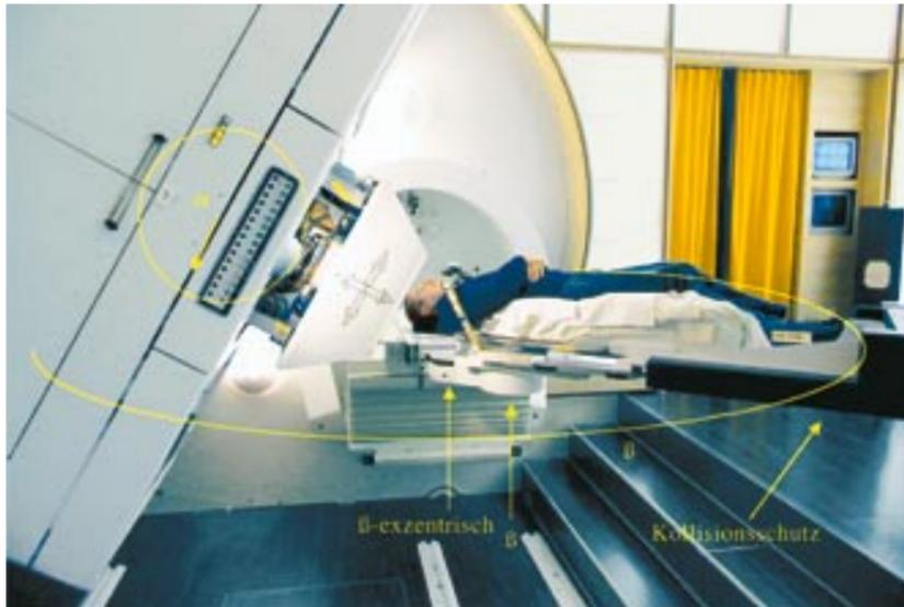
Der revidierte Patiententisch mit Liege, den drei Drehachsen ( $\alpha$ ,  $\beta$ ,  $\beta$ -exzentrisch) und dem neuen Kollisionsschutz.
