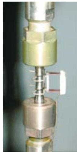
Ein hoch präziser Sensor misst die Dehnungen bei einer Ermüdungsprobe. Damit verbunden ist die Bildung von Martensit, einem Ermüdungsindikator.
