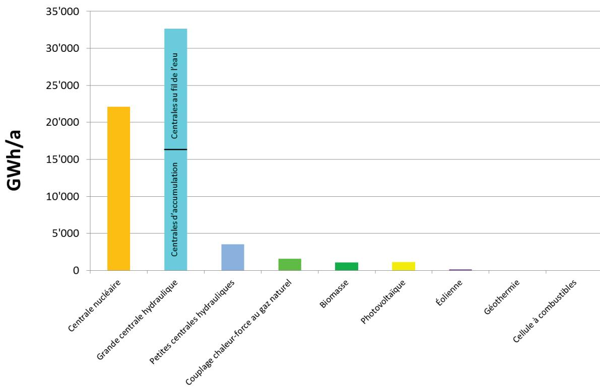
Figure 3.1: Production d'électricité en Suisse en 2015 (BFE/SFOE 2016e, BFE/SFOE 2016g).
