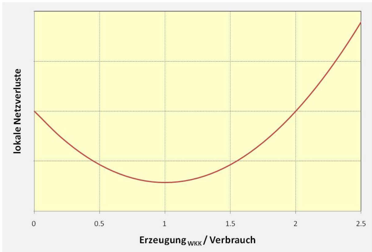
Abbildung 4.2 Idealisierter qualitativer Verlauf der Ohm'schen Verluste im Niederspannungsnetz (Zeitpunkt- resp. Leistungsbetrachtung).
