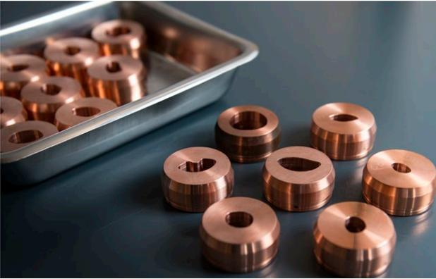
Kollimatoren sind Lochblenden, die am PSI massangefertigt werden. Sie werden vor der Behandlung in eine Apparatur eingespannt, durch die der Protonenstrahl zum Auge geleitet wird. Die in der Form des Tumors gefräste Blende ermöglicht, dass der Protonenstrahl nur auf den Augentumor trifft und das übrige gesunde Gewebe des Auges nicht bestrahlt wird. Diese Technik wird am PSI speziell für Augentumore verwendet.
