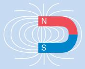
Das magnetisierte Material bleibt in diesem Zustand und wird zu einem Dauermagneten.
