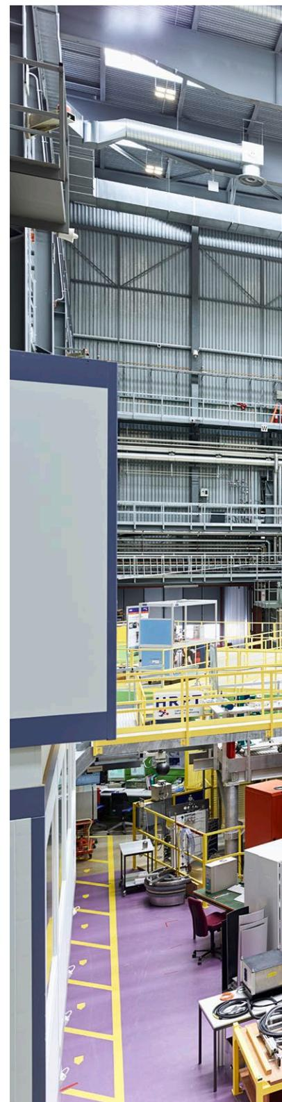
A l'intérieur du hall des cibles de la Source de Neutrons de Spallation Suisse SINQ. Les neutrons sont libérés au centre de l'énorme structure bleue et sont guidés vers les différents instruments autour.
