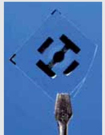
Winziges Kraftwerk: Mini-Brennstoffzelle (ETH Zürich).
