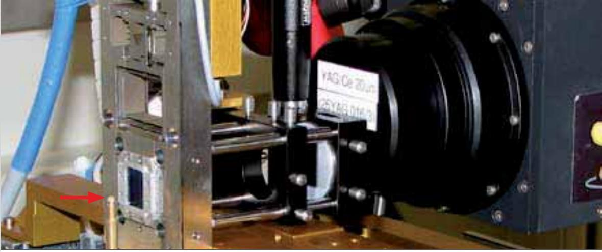
Der Nanokonverter wird an der TOMCAT-Strahllinie direkt hinter der Probe (roter Pfeil) montiert.
