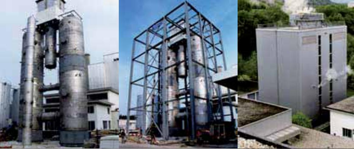
Mit der Versuchsanlage PANDA lässt sich die Sicherheit von Reaktorsystemen analysieren.
