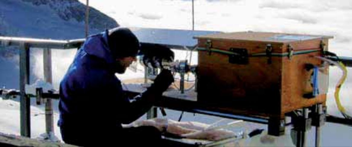
Mit diesem Gerät wird auf dem Jungfrauoch die Verteilung verschieden grosser Aerosole gemessen.
