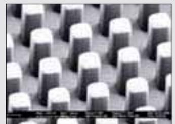
**Geprägte Mikrosäulen:** Noppenstruktur in Polypropylen. Der Säulendurchmesser beträgt ca. 5 tausendstel Millimeter. (Raster-elektronen-Mikroskop-Aufnahme)
