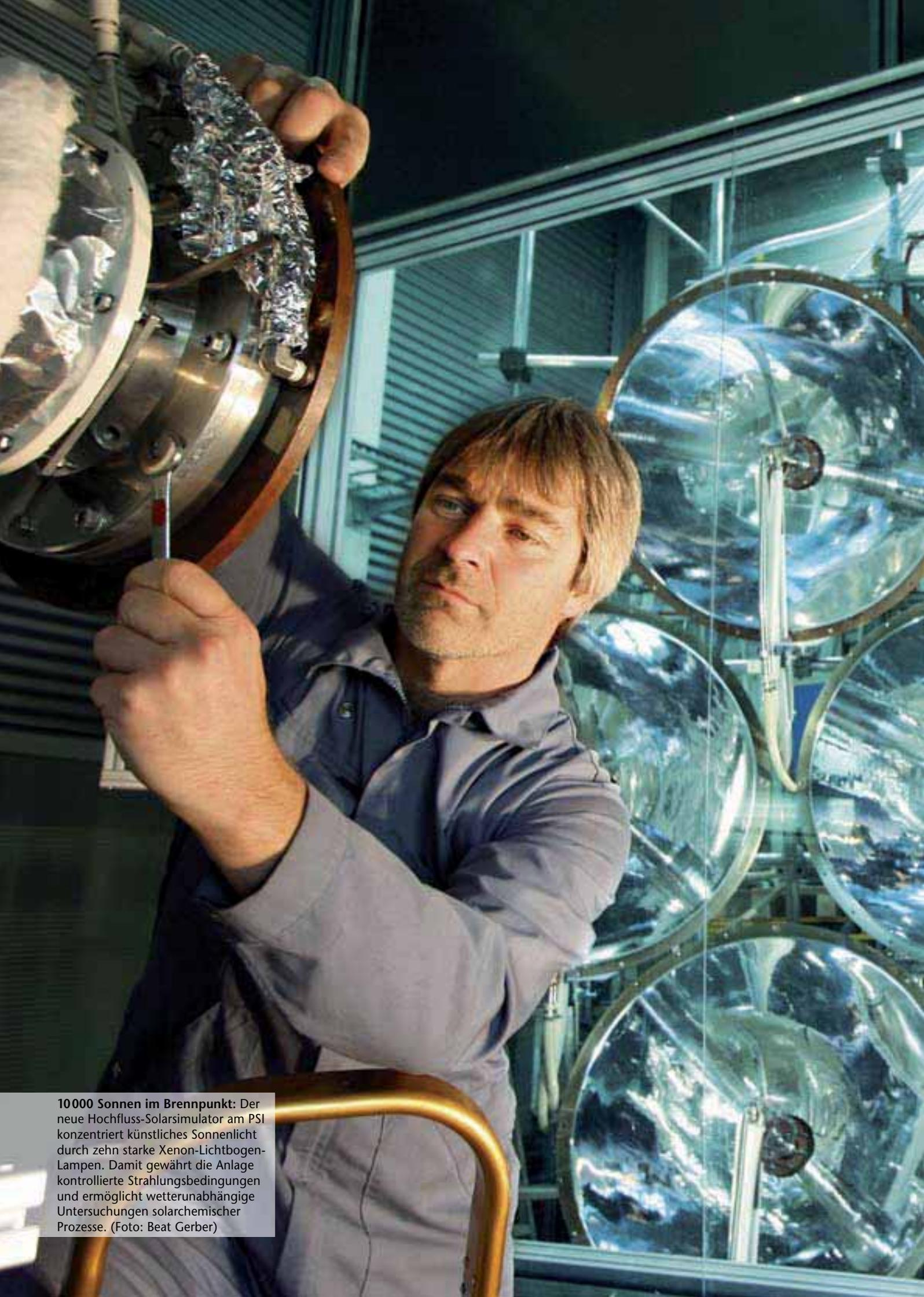
**10000 Sonnen im Brennpunkt:** Der neue Hochfluss-Solarsimulator am PSI konzentriert künstliches Sonnenlicht durch zehn starke Xenon-Lichtbogen-Lampen. Damit gewährt die Anlage kontrollierte Strahlungsbedingungen und ermöglicht wetterunabhängige Untersuchungen solarchemischer Prozesse. (Foto: Beat Gerber)
