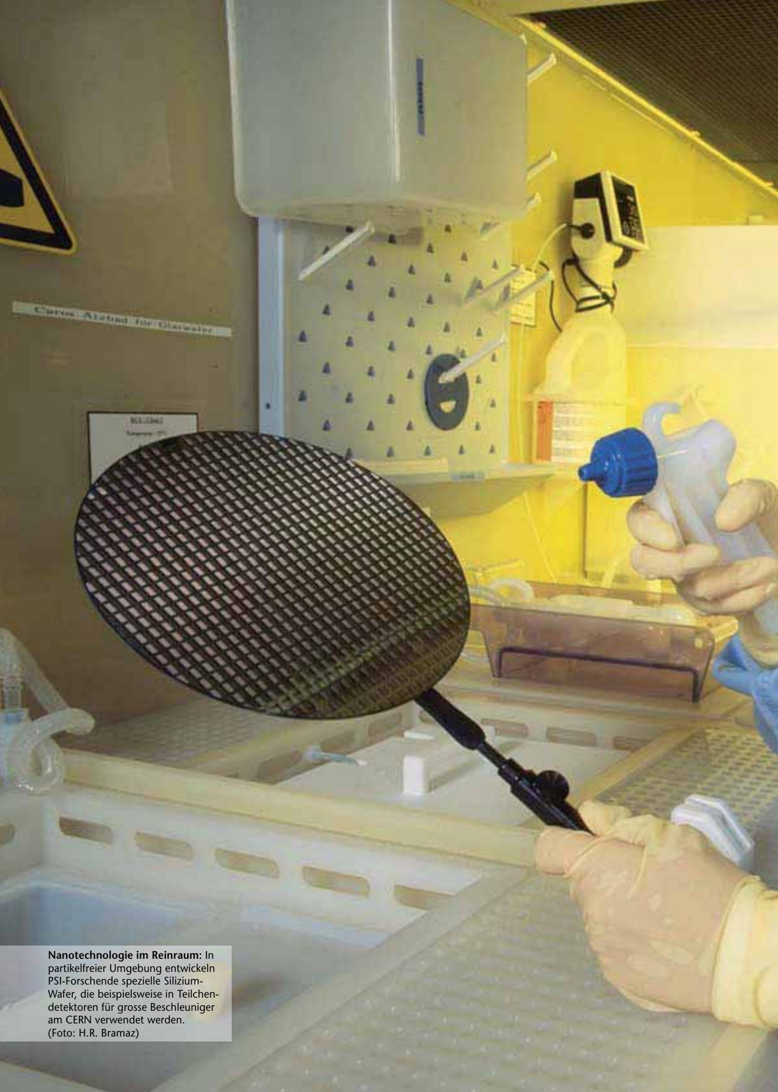
**Nanotechnologie im Reinraum:** In partikelfreier Umgebung entwickeln PSI-Forschende spezielle Silizium-Wafer, die beispielsweise in Teilchendetektoren für grosse Beschleuniger am CERN verwendet werden.
