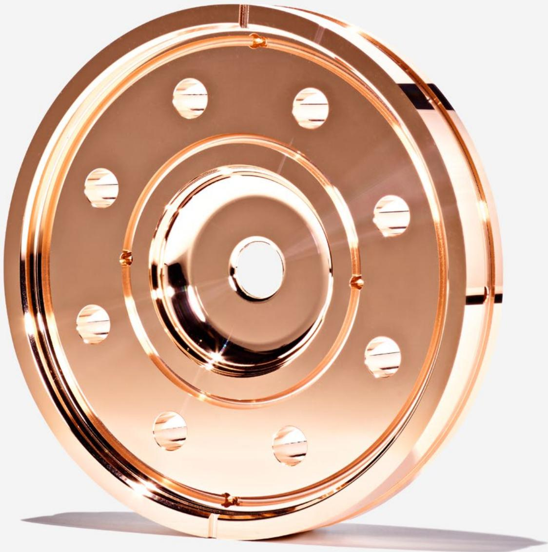
Eine von 11752 Kupferscheiben, die aneinandergereiht das Herzstück des Linearbeschleunigers am Freie-Elektronen-Röntgenlaser SwissFEL bilden. Die Oberfläche jeder Kupferscheibe muss so exakt glatt sein, dass die höchste Unebenheit 25 millionstel Millimeter nicht überschreitet.
