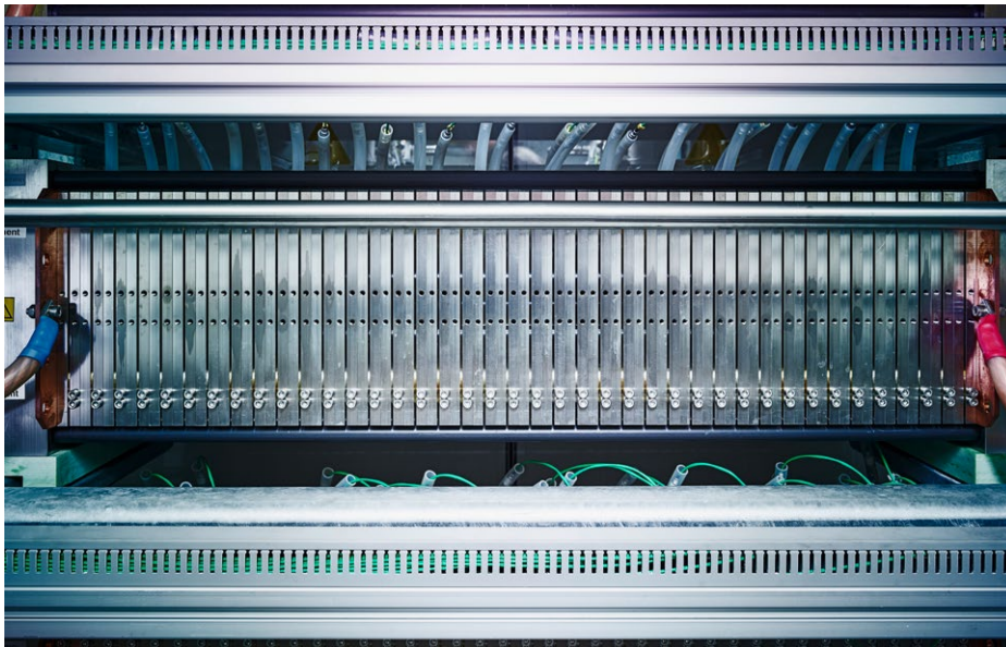
Der Elektrolyseur auf der ESI-Plattform des PSI
