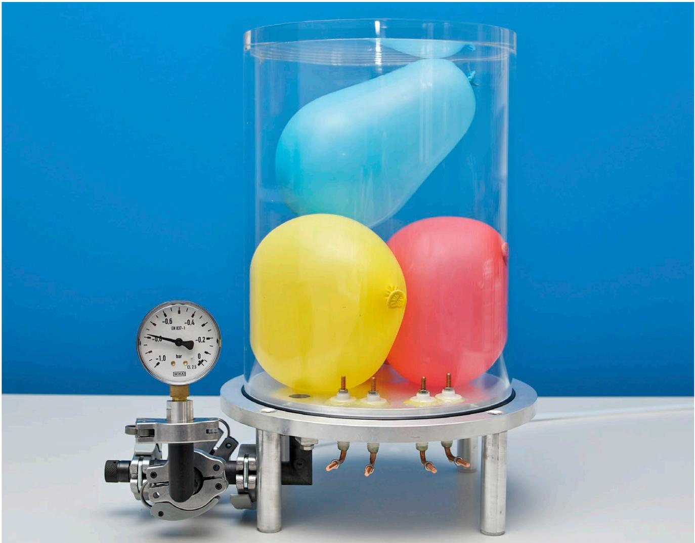
→ Wenn man die Luft in der Vakuumlöcke abpumpt, sind in den Ballons auf gleichem Raum mehr Luftmoleküle vorhanden als ausserhalb. Mit durchschnittlich etwa Schallgeschwindigkeit (343 m/s) stossen diese gegen die Ballonwand und drücken sie nach aussen, ähnlich wie wenn Menschen bei einem Gedränge die Abschränkungen wegdrücken. Deshalb füllen die nur leicht aufgeblasenen Ballons nach und nach fast das ganze Volumen der Vakuumlöcke aus.
