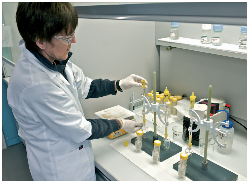
Abbildung 2: Radioanalytisches Labor PSI, Säulenchromatographie, Beispiel für die Separation von Po/Am.
