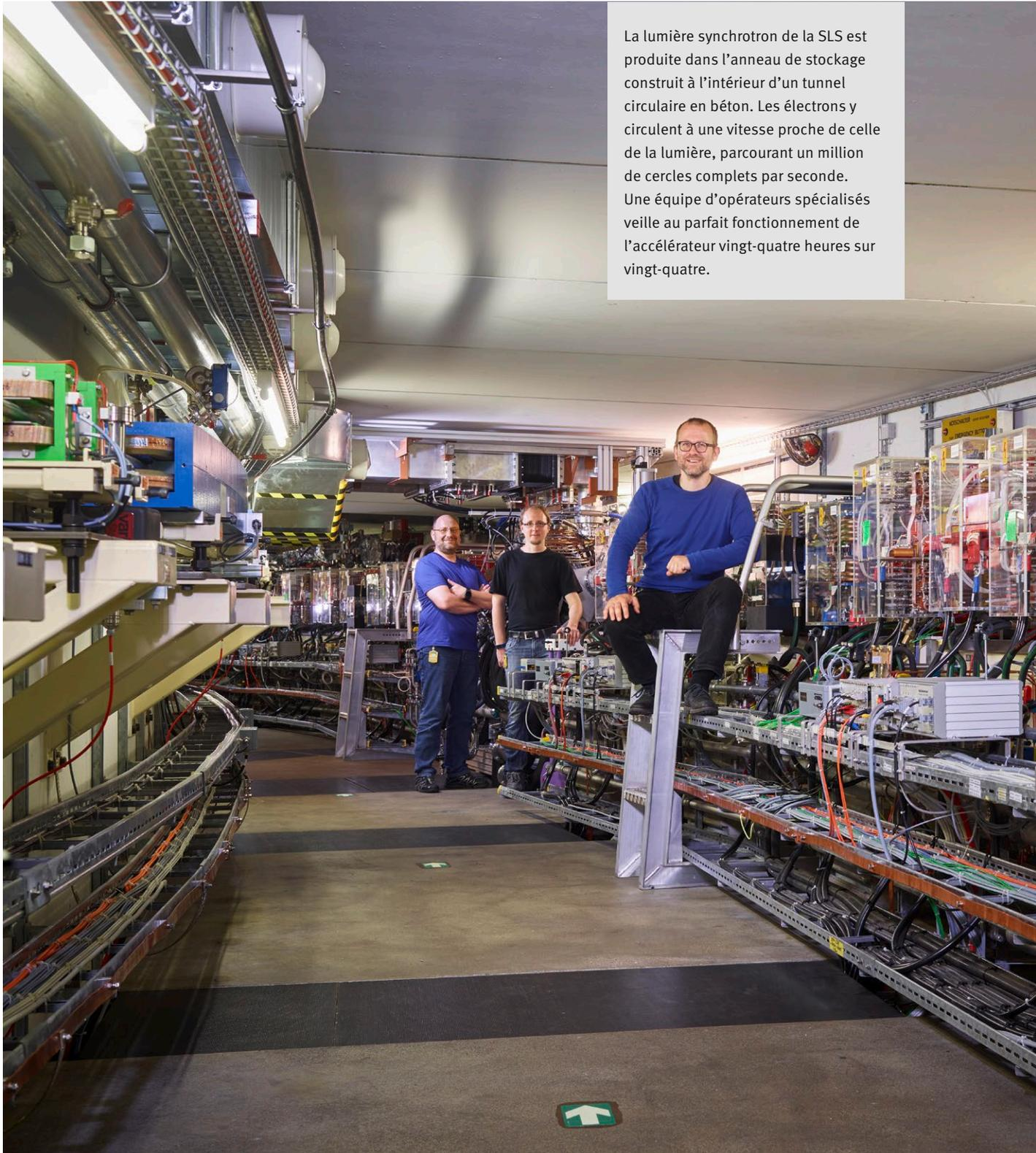
La lumière synchrotron de la SLS est produite dans l'anneau de stockage construit à l'intérieur d'un tunnel circulaire en béton. Les électrons y circulent à une vitesse proche de celle de la lumière, parcourant un million de cercles complets par seconde. Une équipe d'opérateurs spécialisés veille au parfait fonctionnement de l'accélérateur vingt-quatre heures sur vingt-quatre.
